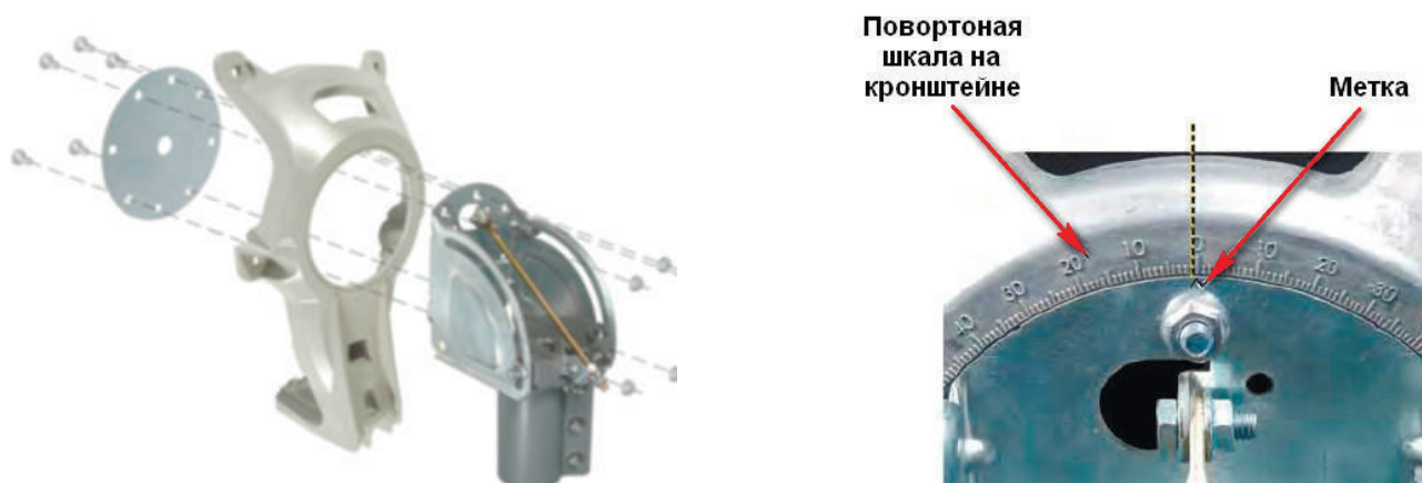
Рисунок 23 – Крепление кронштейна к опорно-поворотному устройству
